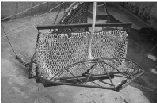
Abb. 3.4.1-3: Mittels einer sogenannten Dredge werden die Muscheln vom Meeresboden abgekratzt und an Bord der Schiffe geholt.
