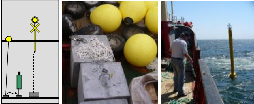
Abb. 7: Schematische Zeichnung der Leuchtspiere mit POD-Verankerungssystem und Fotos des Bojenankers und der Spiere auf See.
