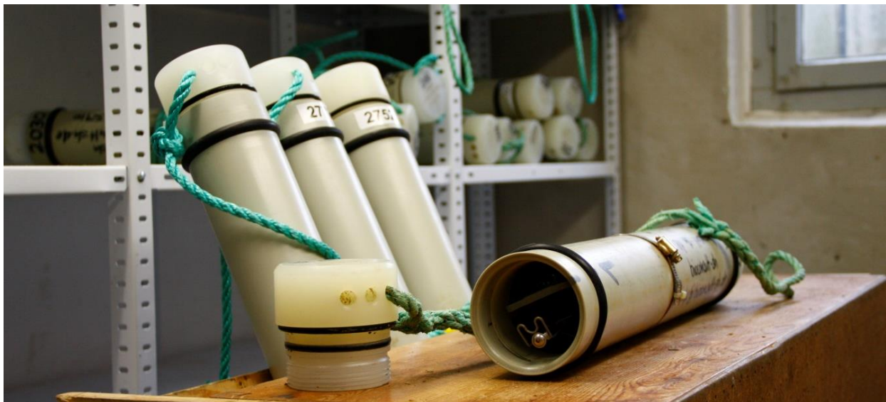
Abbildung 9: C-PODs bereit für die Ausbringung (links) sowie ein geöffneter C-POD (rechts).
